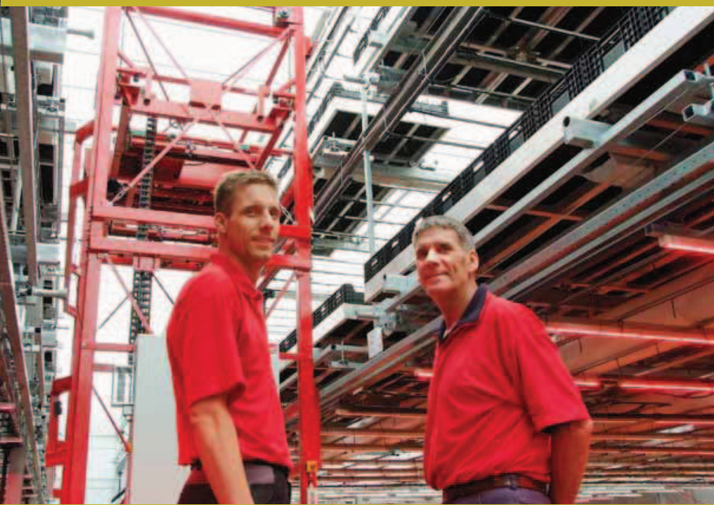
De automatische rijlift op het middenpad tilt de containers van de onderste laag met LED's naar de middelste laag zonder kunstlicht of naar de bovenste laag met daglicht.
